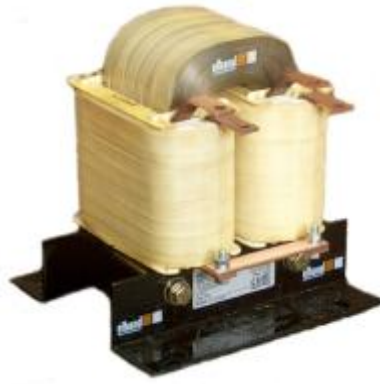
Рис.4. Дроссель типа AD1W - 0,5мГн / 70A dc , f ac =10 кГц с сердечником из аморфного материала, работающий на выходе прерывателя постоянного тока
