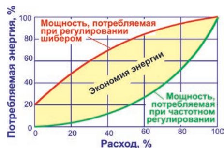
Экономия электроэнергии в вентиляторном оборудовании
