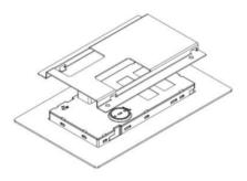
**Шаг 3**: Совместите пазы крепления кронштейна с выемками на задней стороне пульта, нажмите на кронштейн и сдвиньте его вниз в положение фиксации.
