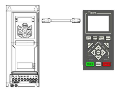
Для подключения пульта к преобразователю частоты используйте интернет-кабель с разъемами RJ45.
