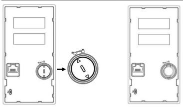
Шаг 1: Снимите крышку (поверните ее против часовой стрелки)
