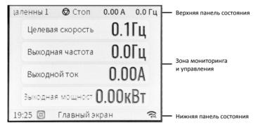
На верхней панели состояния отображается состояние преобразователя — пуск / стоп, выходной ток, выходная частота, как показано ниже:
