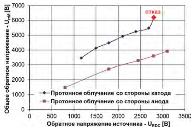
Рис. 8. Зависимости общего обратного напряжения ( U_{RRM} ) от обратного напряжения источника ( U_{RDC} ) для диодов, изготовленных по традиционной технологии, и для экспериментальных диодов
